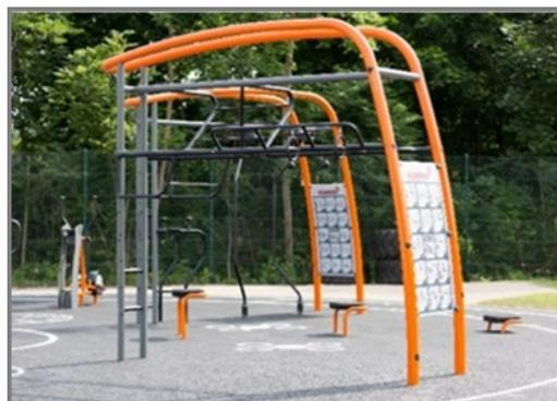
为保证主体框架的完整性，橙色主立柱由  $\varnothing 101.6 \times 3$  毫米钢立柱构成，它是热浸镀锌的，拥有橙色 (RAL2010) 的粉末涂层。支撑立柱接受相同的表面处理，由  $\varnothing 76.1 \times 3.6$  毫米的钢管构成，灰色 (RAL7012) 粉末涂层。
