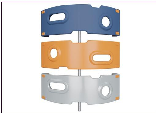
所展示的攀爬部件为一体成型的，壁厚 5 毫米（最低厚度），由可循环的聚乙烯材料制成，抗冲击性强，适用温度范围广，在任何位置都能抵抗破坏。
