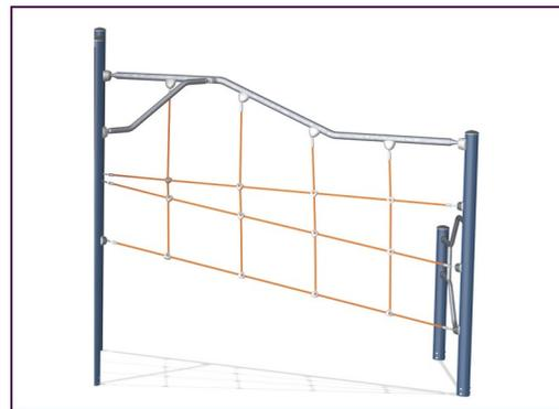
ELEMENTS 绳索具有六股钢丝和钢丝芯。每根丝束都用 PES 纱紧密包裹，然后将其熔化到每根单独的丝束上。在最初的摩擦力去除了表面纤维之后，保留了较硬的 PES 涂层以保护每根股绳，从而使绳索具有极高的耐磨性和防破坏性。
