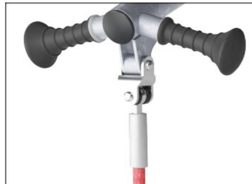
Les deux poignées supérieures inclinées sont composées d'un insert en polypropylène (PP) moulé avec une couche extérieure de caoutchouc TPV souple. La poignée est fixée au tube avec un renfort interne en acier galvanisé afin d'assurer à la fois résistance et durabilité.
