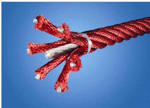
Les cordes Saturne sont fabriquées de 6 torons d'acier et d'une âme métallique en acier. Chaque toron est enveloppé hermétiquement dans du fil en PES. Une fois que le frottement initial a usé les fibres de surface, un revêtement plus dur de PES reste pour protéger chaque brin, garantissant une excellente résistance à l'usure et au vandalisme.
