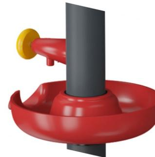
Der integrierte Wasserhahn öffnet sich durch Drücken und das Wasser fließt und es hört auf zu fließen, sobald losgelassen wird. Das Wasser wird durch ein im Inneren des Pfostens befindliches Rohr mit Schlauch- oder Rohranschluss an der Unterseite des Pfostens zugeführt. Die Zufuhr kann entweder über einen losen Schlauch oder über eine permanente Bodenverrohrung erfolgen.
