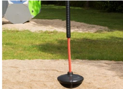
Der speziell entwickelte Sitz ist aus einer Edelstahl einlage gefertigt, der mit einer weichen PUR-Beschichtung versehen ist. Der Sitz wurde im Aufpralltest geprüft und erfüllt die weltweiten Standards für Spielplätze. Am Seil ist ein 100 cm langer ergonomischer PUR-Gummigriff angebracht.
