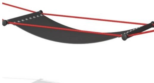
Les membranes Corocord sont constituées d'un matériau caoutchouc résistant au frottement, de qualité équivalente aux tapis roulant et possédant une excellente résistance aux UV. Testé et conforme aux exigences du règlement REACH en matière de HAP. Une armature à quatre couches en polyester tissé est intégrée. L'épaisseur total de la membrane est de 7,5 mm.
