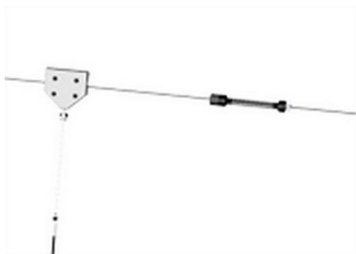
Il cavo in acciaio ha un diametro di 12mm, ed è progettato per resistere ad un uso intenso della teleferica per molti anni. Il punto di partenza è indicato da una manopola. Nella parte finale è presente uno speciale dispositivo a molla che garantisce una frenata suave.
