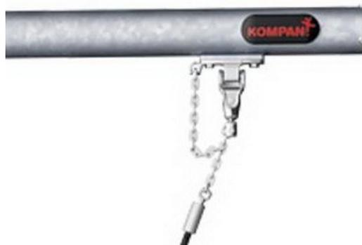
Ganci oscillanti KOMPAN progettati per impieghi con pesi in acciaio inossidabile con funzione anti-torsione. I ganci sono fissati alla traversa su una staffa saldata con due bulloni, i cuscinetti sono incorporati con lubrificante siliconico e non necessitano di ulteriore lubrificazione.
