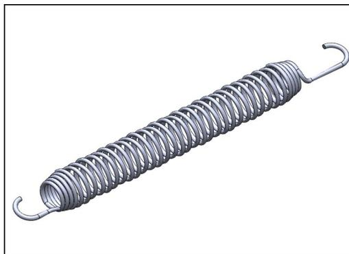
Alle 36 Federn sind aus rostfreiem Stahl gefertigt, um eine lange Lebensdauer und hervorragende Korrosionsbeständigkeit zu gewährleisten. Der Stahldraht ist 3,2 mm dick und die letzten fünf Windungen sind kegelförmig, um eine lange Lebensdauer des Jumpers zu gewährleisten.
