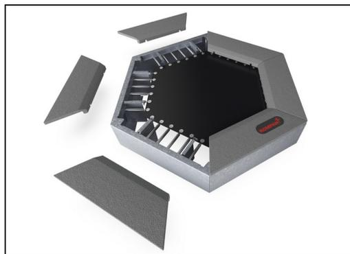
Als einzigartiges Merkmal können die SBR-Platten zur Reinigung und Wartung entfernt werden. Durch Lösen von sechs Schrauben kann die SBR-Platte angehoben werden, um sie zu öffnen und Zugang zu den Federn zu erhalten (siehe Anleitung auf KOMPAN Master).
