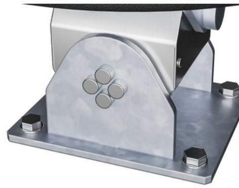
Das doppelte ROSTA-Element ist aus Gusseisen hergestellt und wurde vor dem Lackieren feuerverzinkt. Dies gewährleistet, dass das ROSTA-Element ein wartungsfreies, elastisches Gelenk ist, das in einem Bereich von 250 in jede Richtung bewegt werden kann. Beide Taumelscheiben haben eine unterschiedliche Steifigkeit, der Unterschied beträgt 45%.
