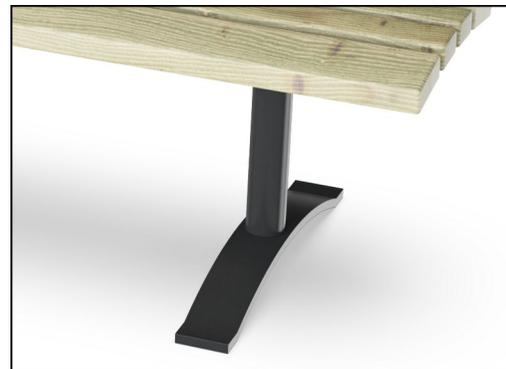
La finitura superiore verniciata a polvere sulla parte superiore della zincatura viene elaborata in due fasi: levigatura leggera e pulizia accurata, verniciatura a polvere - spessore 70-120 µm.
