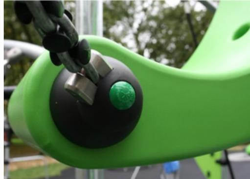
Hohle Kunststoffteile bestehen aus 100 % recycelbarem PE, das zu 33 % aus Post-Consumer-Materialien hergestellt wird. Die abgebildete Spielmuschel wird in einem Stück mit einer Wandstärke von mindestens 5 mm gegossen, um eine hohe Lebensdauer in allen Klimazonen der Welt zu sichern.
