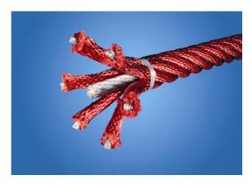
直径大于等于 19mm 的 Corocord 绳索是特殊的"大力神"型镀锌六股钢丝。每根丝束都用 PES 纱紧密包裹,然后将其熔化到每根独立的丝束上。这些绳索具有很高的耐磨性和防破坏性,可以根据需要在现场更换。
