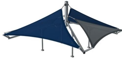
Le maillage des toiles en polyéthylène haute densité (PEHD) est conçu spécialement pour les structures avec toiles d'ombrage. Les toiles sont traitées avec stabilisation UV pour garantir une longue durée de vie. Les toiles sont soutenues par un cadre en acier galvanisé à chaud et resserrées à l'aide de dispositifs en acier inoxydable.
