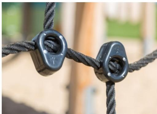
Les filets et les cordes sont fabriqués en PA doté d'une protection contre les UV avec un renforcement des câbles par une armature interne en acier. La corde est traitée par induction afin de créer une soudure solide entre l'acier et la corde et ainsi garantir une excellente résistance à l'usure.
