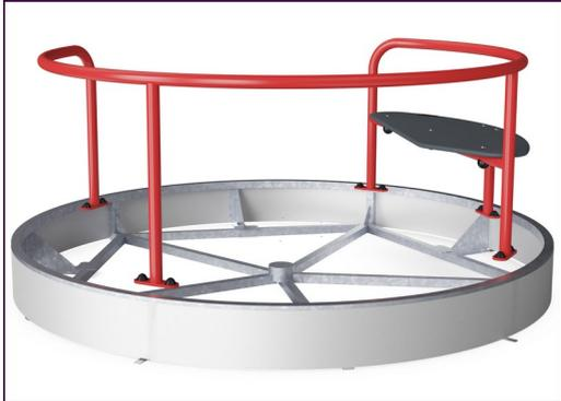
Hochbelastbarer geschweißter Karussell-Unterbau aus Vierkantstahlrohren. Die Stahloberflächen sind vollständig feuerverzinkt. Die Verzinkung hat eine ausgezeichnete Korrosionsbeständigkeit in Außenumgebungen und ist wartungsfrei.
