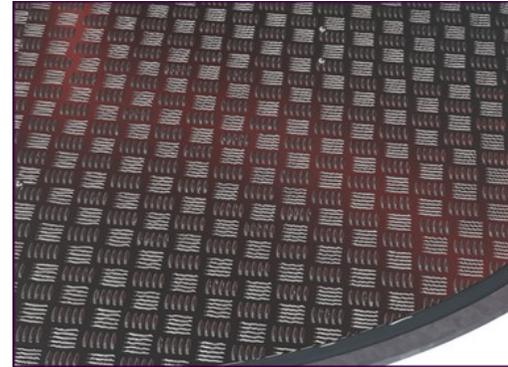
Plattform entweder bestehend aus 3 mm dickem hochwertigem Aluminium mit 2 mm hohem rutschfestem Oberflächenmuster oder aus einer 17,8 mm rutschfesten HPL-Platte. In warmen Klimazonen empfiehlt KOMPAN die rutschfeste HPL-Platte, da die Aluminium-Oberfläche sich durch Sonneneinstrahlung sehr stark aufheizen würde. Beide Platten gewährleisten ein sicheres Spiel für alle Nutzer und sind wartungsfrei.
