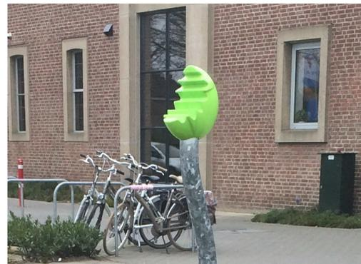
Le dessus coloré est fabriqué en nylon moulé par injection de haute qualité (PA6) avec stabilisation UV afin d'assurer une longue durée de vie. Le design des deux composants est assemblé avec des épingles autour du tube en acier.
