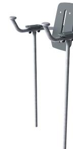
Der Rahmen der Leg Lift-Station ist aus einem HDG-Stahlrohr mit einem Durchmesser von 38 x 2 mm gefertigt. Die Stützplatten bestehen aus 15 mm Ekogrip®, einer 15 mm dicken PE-Platte mit einer 3 mm dicken Deckschicht aus thermoplastischem Gummi mit rutschfestem Effekt. Die Armstützen sind 110 x 195 mm groß, 580 mm voneinander entfernt und 1315 mm über dem Boden. Die Rückenstütze ist 335 x 500 mm groß. Die Aussparung in der Rückenstütze ist 30 x 350 mm groß.
