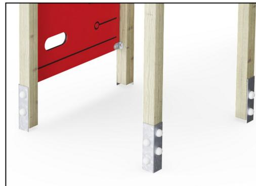
Los postes principales están equipados con zapatas de acero galvanizado en caliente. Las zapatas de acero elevan los postes 20 mm desde el nivel del suelo para evitar el contacto con el material de la superficie.
