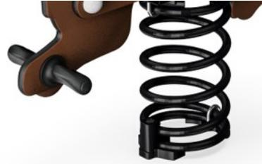
KOMPANI 弹簧由符合 EN10270 的优质弹簧钢制成。弹簧通过磷化处理进行清洁，然后将其涂上环氧底漆和聚酯粉末涂料作为上光油。弹簧通过独特的防夹配件固定，以实现最大的安全性和较长的使用寿命。
