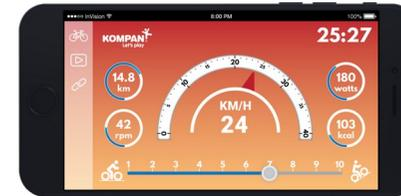
Die Nutzer können das Cardio-Gerät über Bluetooth mit ihrem mobilen Endgerät verbinden. Dadurch erhalten sie eine sofortige Rückmeldung über verschiedene Werte, wie z. B. Trittfrequenz und Kalorienverbrauch. Der Widerstand ist manuell einstellbar (10 Stufen), auf Lehr- und Motivationsvideos kann zugegriffen werden und Aktivitätsdaten lassen sich online speichern und teilen!
