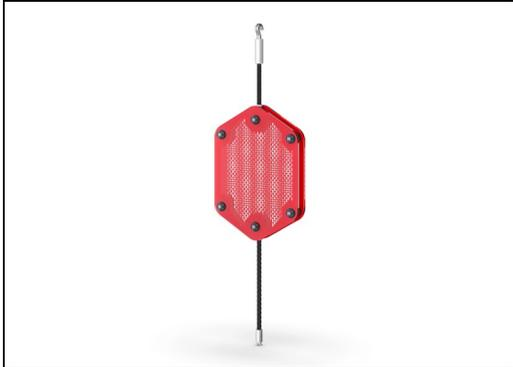
Drehbare optische Spielfeln aus zwei 7 mm dicken Polycarbonatplatten mit einem Abstand von 40 mm. Der innere Grafikdruck besteht aus einer innen liegenden Bildschicht und einer äusseren transparenten Schutzschicht. Sowohl die PC-Platte als auch der Lack auf Wasserbasis sind UV-stabilisiert, um ein Verblässen des Drucks zu verhindern.
