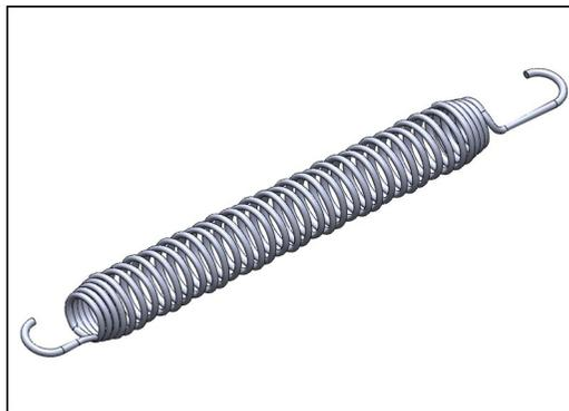
Alle 36 Federn sind aus rostfreiem Stahl gefertigt, um eine lange Lebensdauer und hervorragende Korrosionsbeständigkeit zu gewährleisten. Der Stahldraht ist 3,2 mm dick und die letzten fünf Windungen sind kegelförmig, um eine lange Lebensdauer des Jumpers zu gewährleisten.
