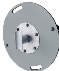
Das Lagergehäuse ist aus feuerverzinktem Stahl gefertigt. Die Lagerwelle ist aus rostfreiem Stahl AISI304 gefertigt. Das Lager selbst besteht aus Polyoxymethylen (POM), einem technischen Thermoplast mit hoher Steifigkeit, geringer Reibung und ausgezeichneter Formbeständigkeit.
