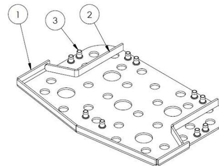
Una piastra in acciaio al carbonio zincato a caldo da 5 mm deve essere modellata all'interno dell'SBR per offrire stabilità ottimale e ottimizzare il montaggio del gradino sul telaio.
