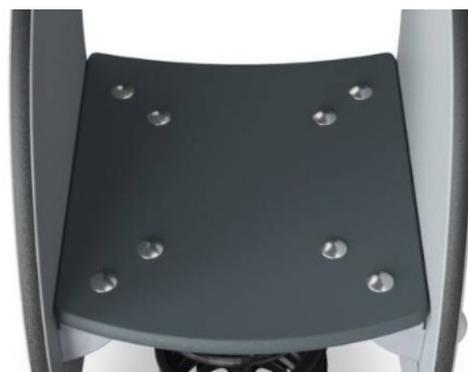
La seduta è realizzata in pannello Ekogrip® costituito da una base in PE di spessore 15 mm con strato superiore in gomma morbida da 3 mm con effetto antiscivolo.
