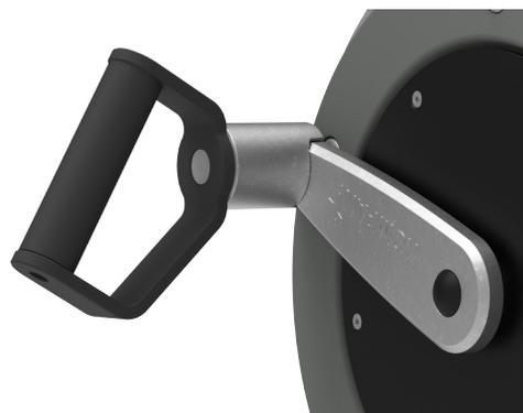
Die ergonomisch geformten Griffe ermöglichen 3 Übungspositionen im Stehen, Sitzen oder aus dem Rollstuhl. Die Griffe haben einen Durchmesser von Ø 36 mm und sind in einem Winkel von 30 Grad angebracht. Die Polyurethabeschichtung sorgt für einen guten Griff und angenehmen Halt.
