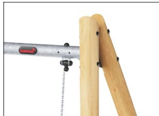
Les suspensions pivots sont fabriquées en nylon de haute qualité stabilisé aux UV (PA6) avec des roulements à billes intégrés et scellés à vie. Les chaînes réglables en hauteur sont fixées par un crochet en acier inoxydable avec un boulon snake-eye antivol dans un boîtier rotatif anti-torsion. Tous les sièges avec deux chaînes de fixation sont disponibles avec une suspension standard ou une suspension anti-enroulement.
