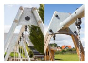
La struttura ad "A" delle altalene è progettata con una traversa ø100mm zincata a caldo con grandi piastre terminali in acciaio per un fissaggio sicuro delle due opzioni di montante: acciaio ø70mm zincato a caldo. Legno di pino impregnato con basi in acciaio zincato a caldo.
