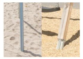
Il palo delle altalene A-Frame è disponibile per l'ancoraggio superficiale con bulloni di espansione o interrato con profondità di 60 cm o 90 cm. Le gambe in acciaio zincato a caldo sono ancorate direttamente nel terreno. I pali in legno di pino sono rialzati da terra da un unico basamento in acciaio zincato a caldo profilato.
