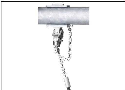
Colgadores de acero inoxidable de diseño resistente KOMPAN con función anti-torsión. Los soportes están unidos al poste transversal en un soporte soldado con dos pernos. Los cojinetes están incrustados con lubricante de silicona y no necesitan más lubricación.
