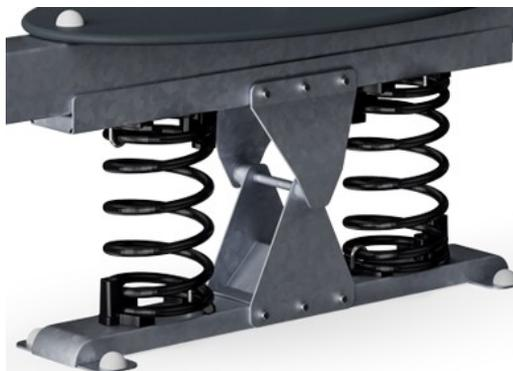
Los muelles KOMPAN están hechos de acero de resorte de alta calidad según EN10270. Los muelles se limpian mediante fosfatación antes de pintarlos con una imprimación epoxi y un recubrimiento de poliéster en polvo como acabado superior. Los muelles se fijan mediante accesorios anti-pelliczos únicos para máxima seguridad y larga vida útil.
