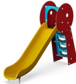
Geformte PE-Rutschen aus 33% Post-Consumer-Materialien in verschiedenen Farben in einem Stück mit einer Wandstärke von mindestens 5 mm. Das PE ist auf UV-Beständigkeit getestet und hat eine ausgezeichnete Schlagzähigkeit und ist innerhalb einer grossen Temperaturspanne verwendbar.
