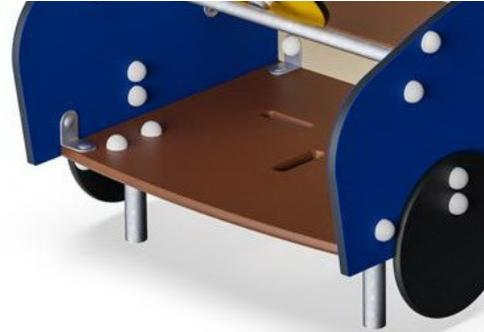
Die Sitze sind aus 22 mm starken Siebträgerplatten aus Erlen- und Kiefernholz gefertigt. Beide Seiten sind mit 2 Lagen Phenolfilm mit Antirutsch-Beschichtung bedeckt. Alle Schnittkanten sind mit Farbe versiegelt, um eine lange Lebensdauer zu gewährleisten.
